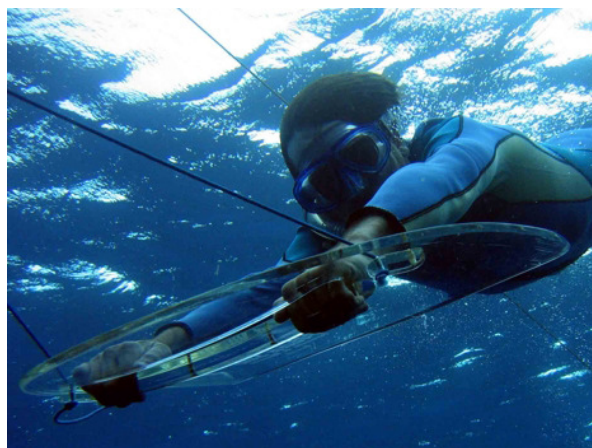
Figura 5.2. Aspecto da prancha de mergulho rebocado feita de policarbonato transparente.
