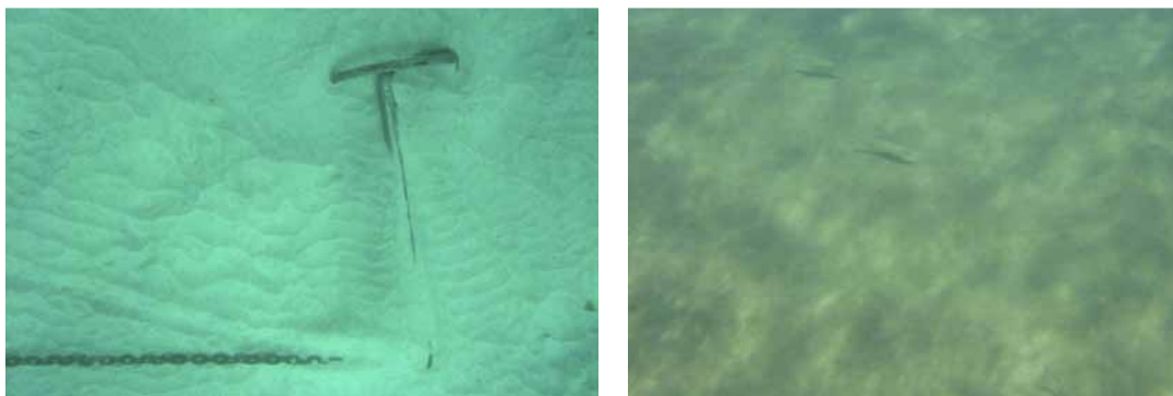
Figura 4.1. Fotos mostrando o posicionamento da âncora no substrato e a situação do substrato após a retirada da âncora. Nenhum distúrbio visual foi detectado.
